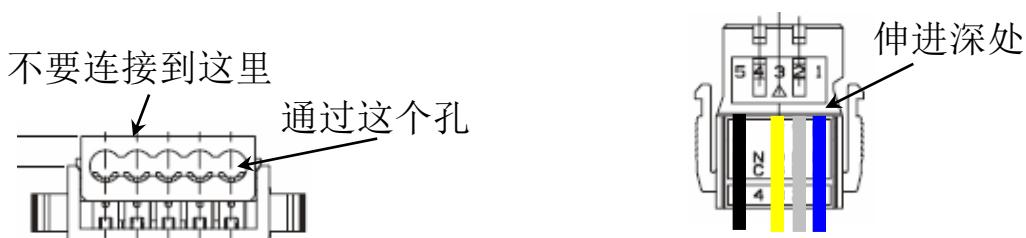
(4) 请用工具按住连接器的外盖，将各信号线固定。
