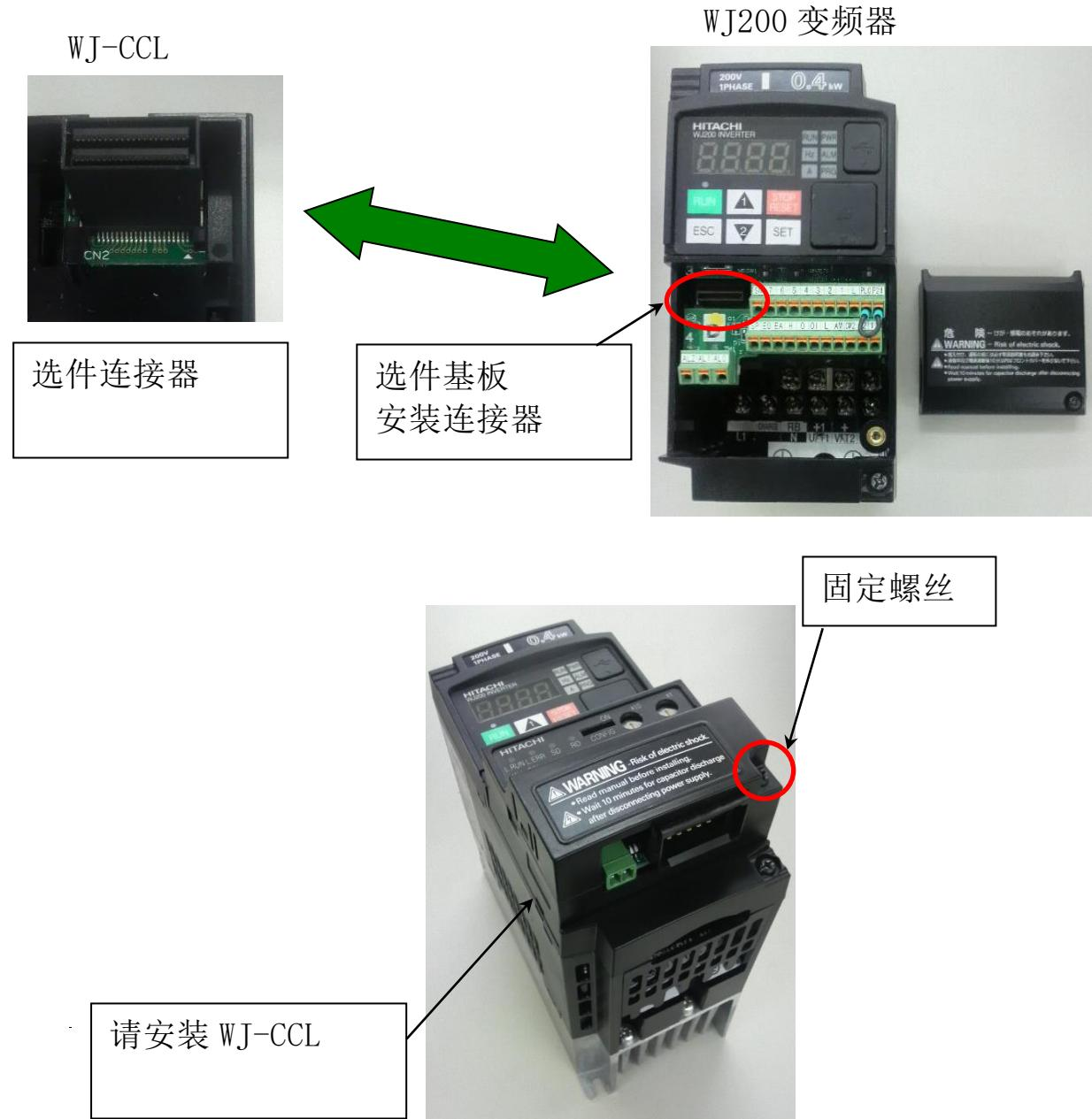
请确保变频器的选件基板安装连接器和 WJ-CCL 的选件紧密安装、无松动。若连接器的连接状态有问题，变频器打开电源后有可能出现选件外装错误（编号：E69□、请参考第九章）。或者，也有可能出现变频器无法识别选件，无法进行正常的通信的情况。
